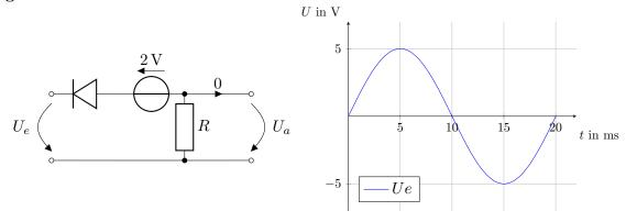
Am Eingang der Schaltung liegt die skizzierte Sinusspannung. Bestimmen und zeichnen Sie den Verlauf der Spannung  $U_a$  am leerlaufenden Ausgang. Nehmen Sie dazu die Schwellenspannung der Diode mit  $0.7\,\mathrm{V}$  an.
