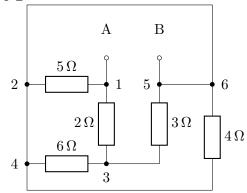
Berechnen Sie den Ersatzwiderstand  $R_{AB}$  der angegebenen Widerstandskombination.
