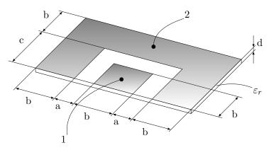
Eine dünne Platte aus dielektrischem Material ist beidseitig metallisch beschichtet: Auf der Unterseite durchgehend, auf der Oberseite strukturiert wie in der Zeichnung angegeben. Berechnen Sie näherungsweise (ohne Berücksichtigung von Randstörungen) die Kapazität  $C_{12}$  zwischen den Kontaktpunkten 1 und 2.
