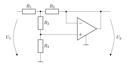
Geg.:  $R_1$ ,  $R_2$ ,  $R_3$ ,  $R_4$ Ges.:  $\frac{U_1}{U_2}$
