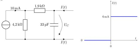
In der gezeichneten Ersatzanordnung, die eine Gleichstromquelle enthält, wird zusätzlich der Strom I(t) wie angegeben eingeprägt.
