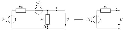
Die links eingezeichnete Ersatzschaltung enthält eine unabhängige Spannungsquelle  $(U_0)$  und eine linear stromgesteuerte Spannungsquelle  $(\gamma I_1)$ .
