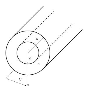
Zwischen den beiden Anschlüssen eines Koaxialkabels, das mit einem Dielektrikum der Permittivität  $\varepsilon$  ausgefüllt ist, liegt die elektrische Spannung U. Berechnen Sie allgemein den Betrag der elektrischen Feldstärke am Innenleiter.
