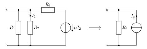
Die links angegebene Schaltung mit einer stromgesteuerten Spannungsquelle ist in eine äquivalente Stromquelle umzuwandeln. Bestimmen Sie die Parameter  $R_i$  und  $I_q$ .  $(R_1,$  $R_2$ ,  $R_3$  und  $\alpha$  sind gegeben)
