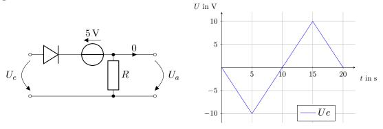
Am Eingang der Schaltung liegt die skizzierte Dreieckspannung. Bestimmen und zeichnen Sie den Verlauf der Spannung  $U_a$  am leerlaufenden Ausgang. Nehmen Sie dazu die Schwellenspannung der Diode mit  $0.7\,\mathrm{V}$  an
