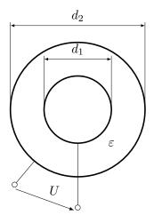
Zwischen den beiden Elektroden eines Kugelkondensators, der mit einem Dielektrikum der Permittivität  $\varepsilon$  ausgefüllt ist, liegt die elektrische Spannung U. Berechnen Sie allgemein die Dichte der sich auf der inneren Elektrode einstellenden Flächenladung.
