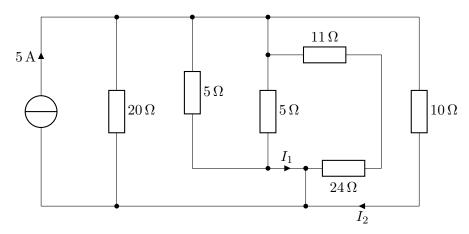
Berechnen Sie für die angegebene Schaltung das Stromverhältnis  $\frac{I_1}{I_2}.$
