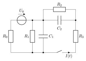
In der gezeichneten Schaltung ist der Schalter S zunächst über längere Zeit geöffnet und wird zum Zeitpunkt t=0 geschlossen. Berechnen Sie allgemein die Stromstärke  $I(0_+)$  über den Schalter unmittelbar nach dem Schließen.
