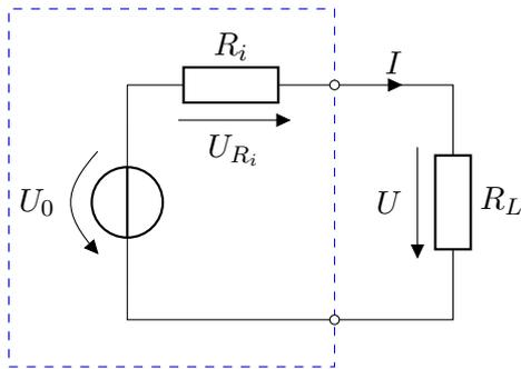
Berechnen Sie den Wert des Lastwiderstands  $R_L$ , bei dem die Leistung  $P_L$  an diesem Verbraucher den Maximalwert erreicht. Berechnen Sie anschließend den Wert der maximalen Ausgangsleistung  $P_{Lmax}$ .
