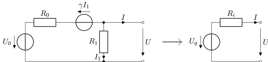
Die links eingezeichnete Ersatzschaltung enthält eine unabhängige Spannungsquelle ( $U_0$ ) und eine linear stromgesteuerte Spannungsquelle ( $\gamma I_1$ ).
