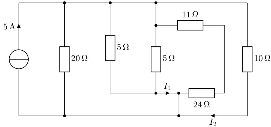
Berechnen Sie für die angegebene Schaltung das Stromverhältnis  $\frac{I_1}{I_2}$ .
