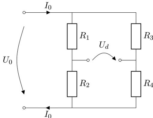
Dargestellt ist eine Widerstandsbrücke. Berechnen Sie die Differenzspannung  $U_d$  im Querzweig. Alle Widerstände und die angelegte Spannung  $U_0$  sind bekannt.
