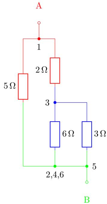
$$R = (2\ \Omega + 6\ \Omega // 3\ \Omega) // 5\ \Omega \quad (6)$$
