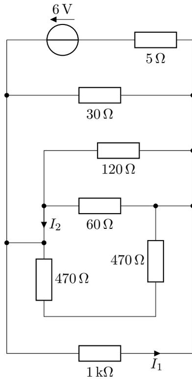
Berechnen Sie für die angegebene Schaltung das Stromverhältnis  $\frac{I_2}{I_1}$ .
