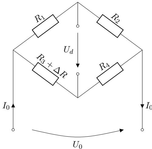
Dargestellt ist eine ausgeglichene Viertelbrücke mit den Werten  $R_1 = 300\Omega$ ,  $R_2 = 150\Omega$ ,  $R_3 = 200\Omega$  und  $R_4 = 100\Omega$  an der eine Spannung von  $6V$  anliegt.
