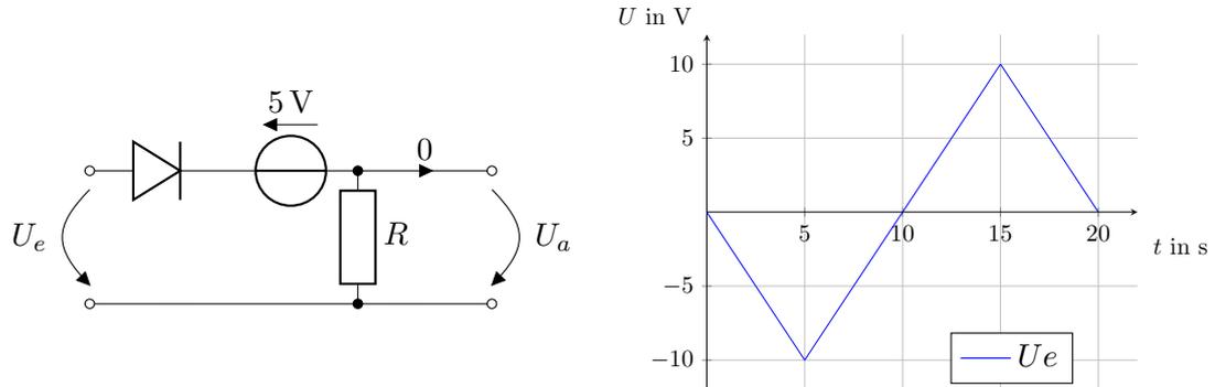
Am Eingang der Schaltung liegt die skizzierte Dreiecksspannung. Bestimmen und zeichnen Sie den Verlauf der Spannung  $U_a$  am leerlaufenden Ausgang. Nehmen Sie dazu die Schwellenspannung der Diode mit  $0,7\text{V}$  an
