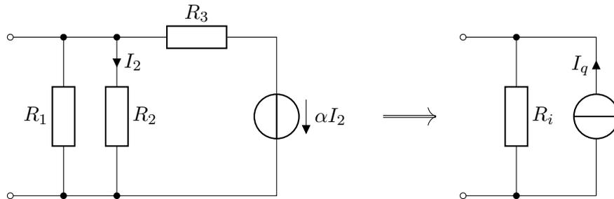
Die links angegebene Schaltung mit einer stromgesteuerten Spannungsquelle ist in eine äquivalente Stromquelle umzuwandeln. Bestimmen Sie die Parameter  $R_i$  und  $I_q$ . ( $R_1$ ,  $R_2$ ,  $R_3$  und  $\alpha$  sind gegeben)
