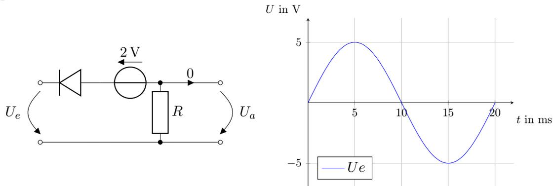
Am Eingang der Schaltung liegt die skizzierte Sinusspannung. Bestimmen und zeichnen Sie den Verlauf der Spannung  $U_a$  am leerlaufenden Ausgang. Nehmen Sie dazu die Schwellenspannung der Diode mit  $0,7\text{V}$  an.
