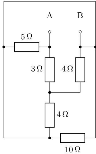
Berechnen Sie den Ersatzwiderstand  $R_{AB}$  der angegebenen Widerstands-kombination.
