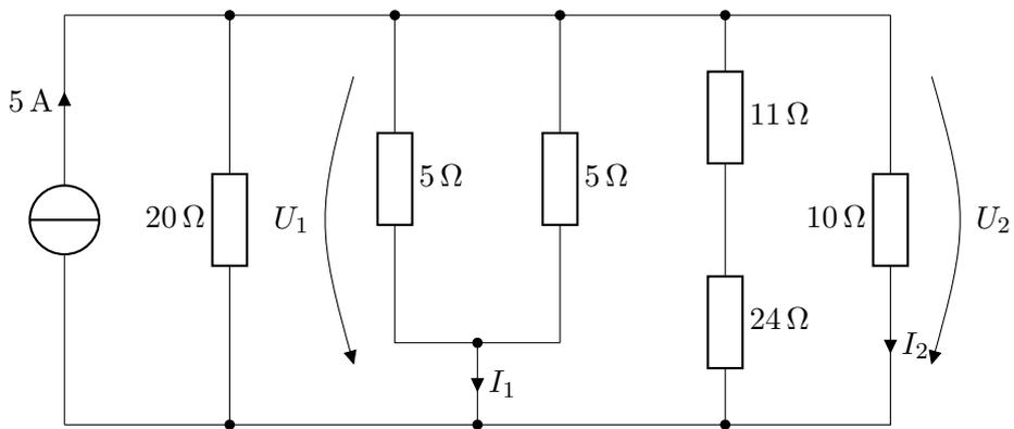
$$\frac{I_1}{I_2} = \frac{10 \Omega}{5 \Omega // 5 \Omega} = \frac{10 \Omega}{2,5 \Omega} = 4 \quad (11)$$
